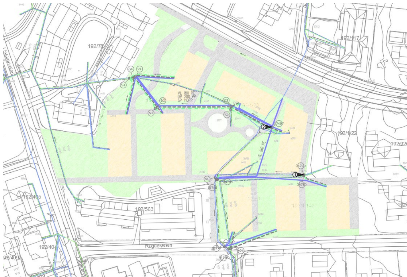
Figur 3 – Prosjektert vann- og avløp
