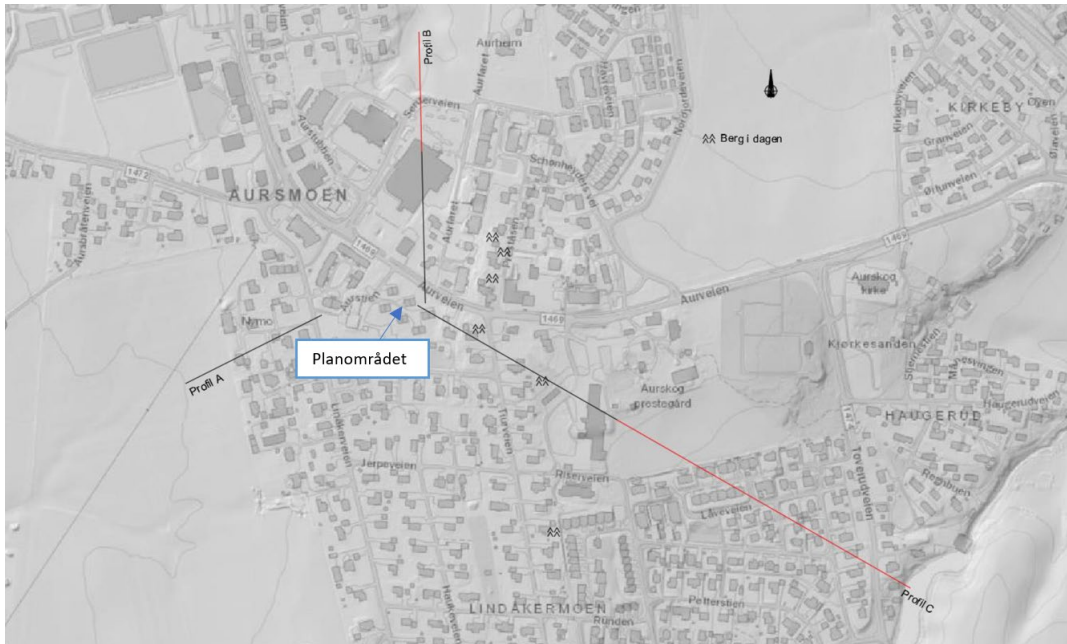
FIGUR 34: KART SOM VISER VALGTE, KRITISKE TERRENGPROFILER FOR TILTAKET, RØD DEL AV PROFILLINJA INDIKERER AT AKTSOMHETSOMRÅDET FOR LØSNEOMRÅDE (VURDERING AV OMRÅDESTABILITET, 24.02.2022)
